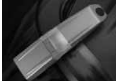
Fig.5.8. Sistema de proyección de la información en el horizonte. Detalle de la unidad sujeta a la pantalla del casco.
