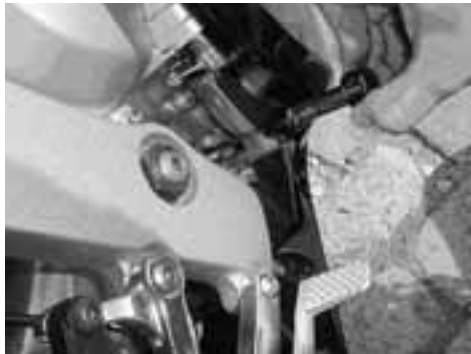
Figura 6.7: Comprobación del nivel de aceite de una moto
