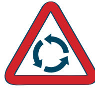
Intersección con circulación giratoria
