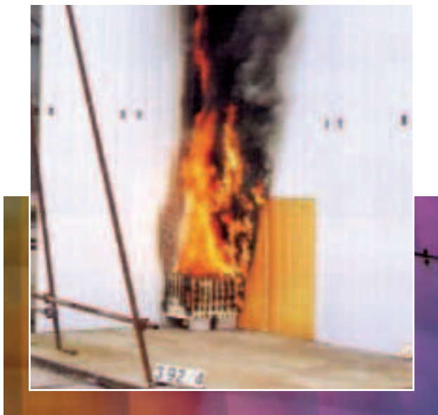
Foto 14. Ensayo de esquina de Factory Mutual.
